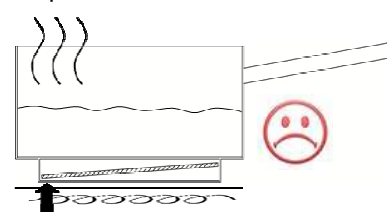
Elemento ferromagnético no paralelo al inductor
